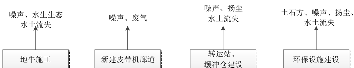
图5.1—1 项目施工内容及产污环节图
